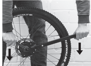
Abbildung 5: Aufsetzen des POM- Sprocket-Keys auf das Rear Sprocket M46x6
