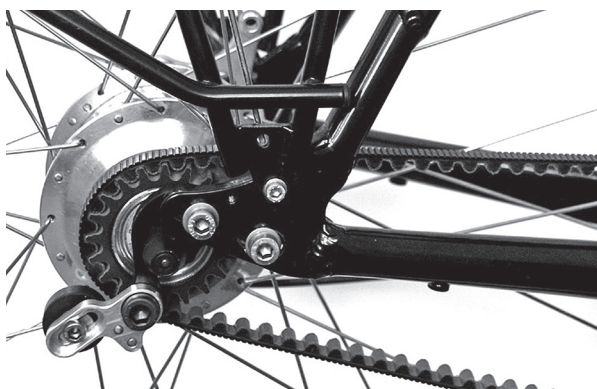
Abbildung 3: Beispiel zur Rahmenkonstruktion: Teilung der Sitzstrebe
